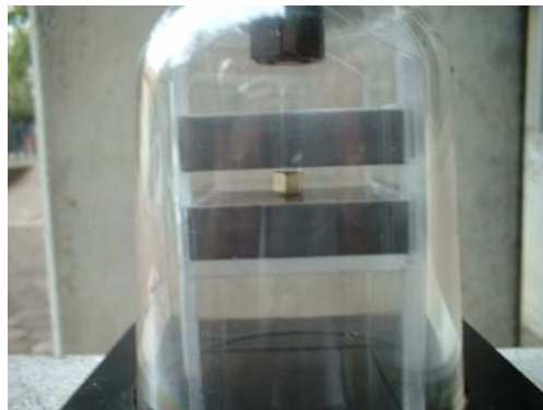
Figura 1. Imán levitado entre dos placas de grafito.
