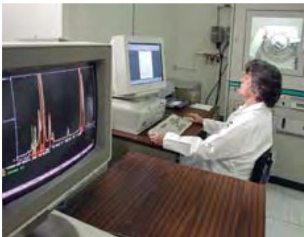
En el Laboratorio de Difracción de Rayos X se realiza el análisis de materiales, la identificación de fases cristalinas, espectrometría, y el análisis elemental cualitativo a partir de flúor.
