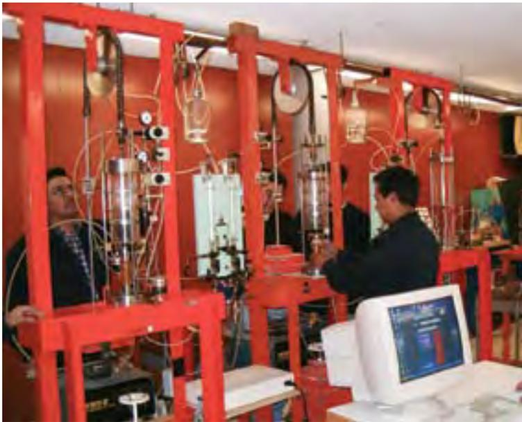
Pruebas dinámicas de tipo torsional en suelos, Laboratorio de Geotecnia del II.
