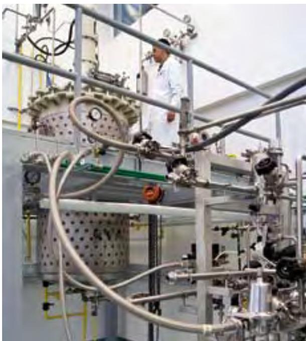
Fermentador de 1 000 litros y centrífuga para purificación por filtros de la planta piloto de escalamiento industrial del IIB.
