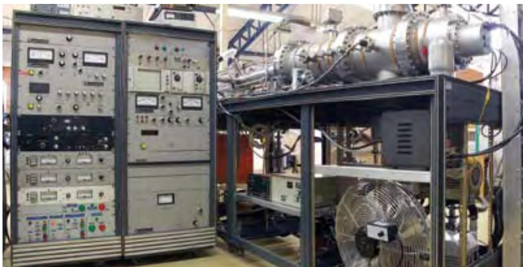
Tubo de deriva con espectrometría de masas para el estudio del movimiento de iones y de sus reacciones con moléculas de un gas neutro.
