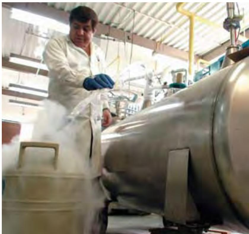
Instalaciones del licuefactor del IIM para la fabricación de nitrógeno líquido, el cual es utilizado para mantener en condiciones de operación los equipos de investigación.
