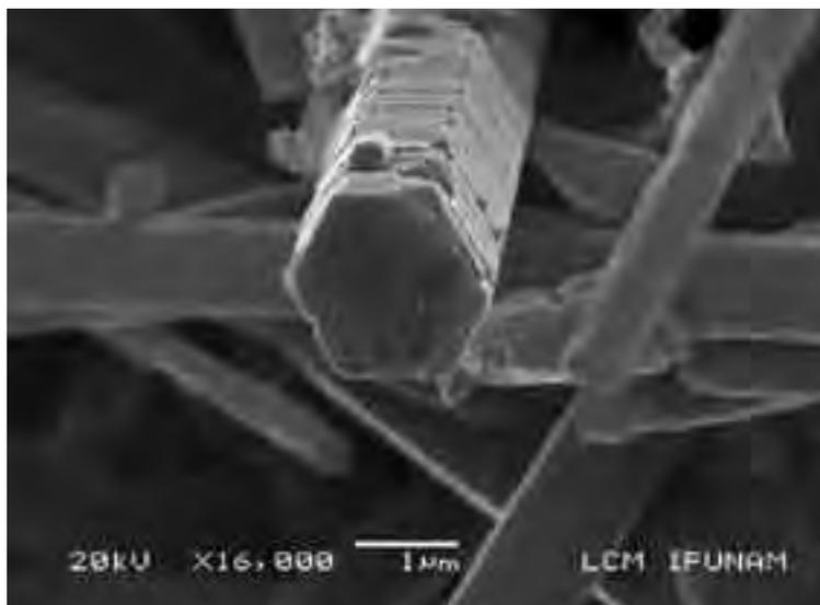
Imagen de nanoalambres de óxido de zinc obtenida por métodos solvotermales mediante un microscopio electrónico de barrido de bajo vacío. Se reconoce la faceta hexagonal que muestra el crecimiento del cristal. Las dimensiones más pequeñas que se observan son de 2 micrómetros.
