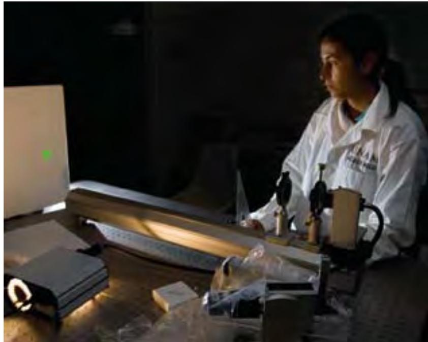
Medición del índice de refracción en medios uniaxiales.
