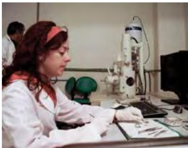
El CFATA comparte la Unidad de Microscopía del Campus Juriquilla con el Instituto de Neurobiología y el Centro de Geociencias. Se aprecian el microscopio electrónico de barrido de bajo vacío y preparaciones para el mismo.
