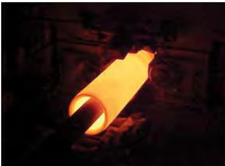
Deformación de una pieza de acero para obtener tubería.
