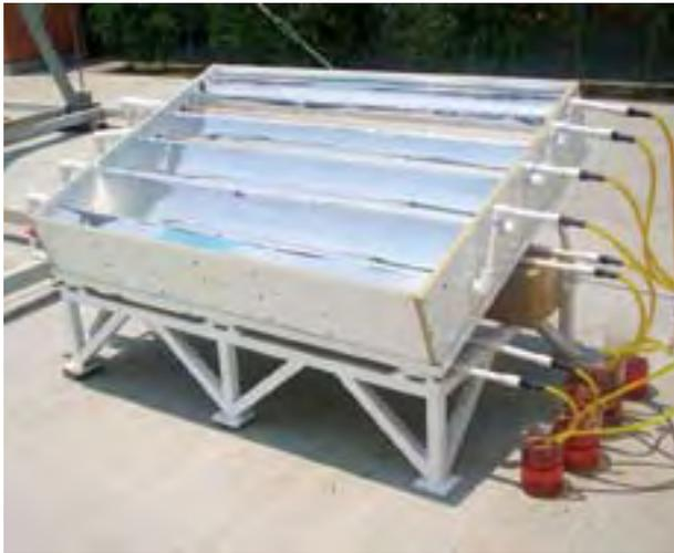
Concentrador Parabólico Compuesto Múltiple, para estudios de fotocatalisis heterogénea. Prototipo para un posible producto tecnológico dirigido al tratamiento de aguas residuales contaminadas con compuestos orgánicos tóxicos: detergentes, plaguicidas, fenoles y colorantes textiles, entre otros.
