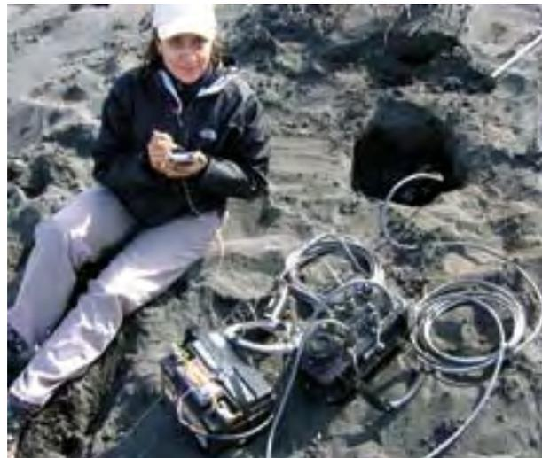
Instalación de sismógrafos para estudios de sismicidad local y regional y de la estructura interna de la Tierra.
